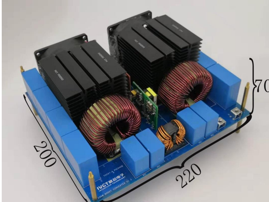
图 3-1 20kW 交错式 DC-DC 升压电路实物图（尺寸为毫米）
